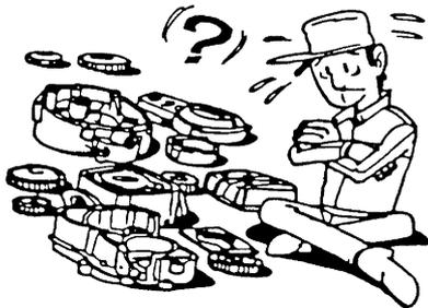
4. Lors du démontage, nettoyer toutes les pièces et les mettre sur des plateaux dans l'ordre du démontage. Ceci diminuera le temps de remontage et permettra d'être sûr que toutes les pièces sont correctement reposées.
